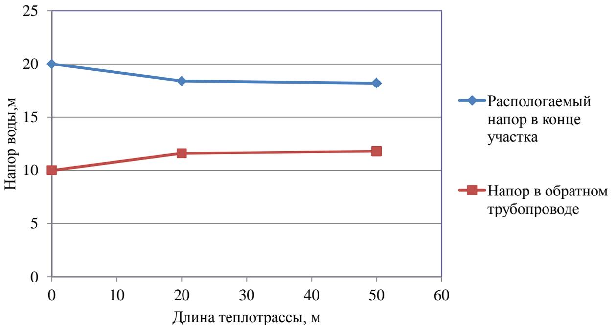
Рисунок 2.4 – Пьезометрический график тепловой сети школьной котельной с. Нижнетобольное
