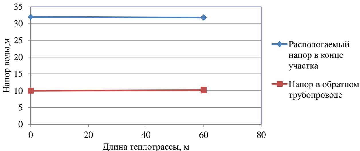
Рисунок 2.6 – Пьезометрический график тепловой сети котельной детского сада с. Нижнетобольное по второму магистральному выводу Котельная – здание администрации
