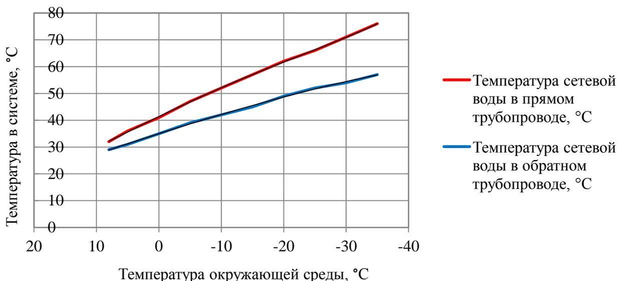
Рисунок 2.3 – График изменения температур теплоносителя
