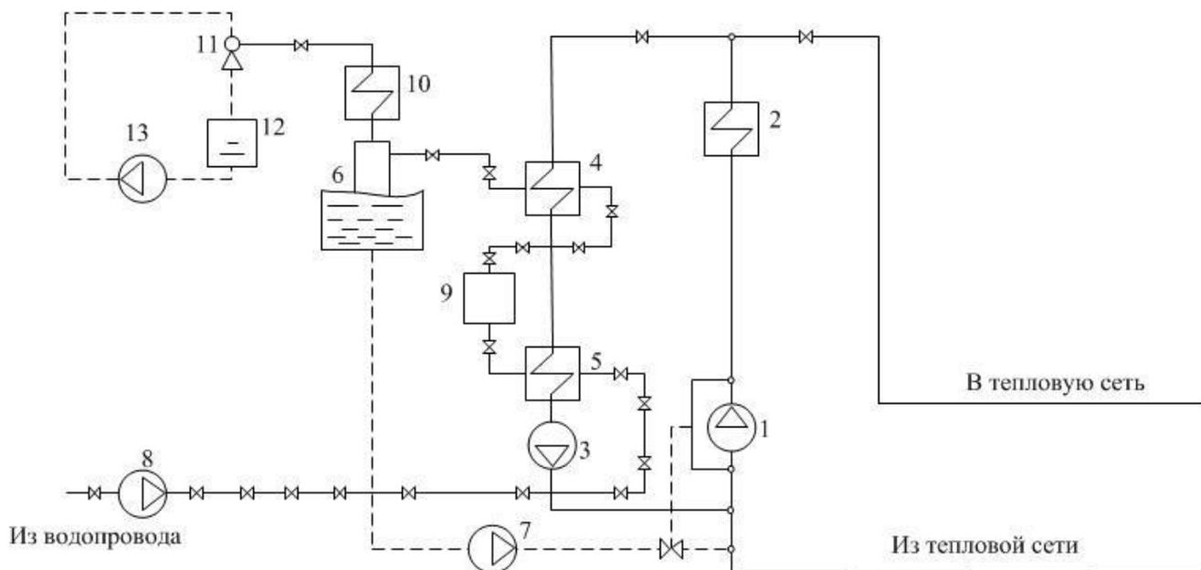
Рисунок 2.2 – Принципиальная тепловая схема котельной с водогрейными котлами:
