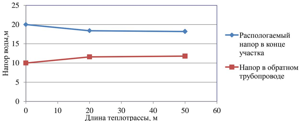
Рисунок 2.7 – Пьезометрический график тепловой сети школьной котельной с. Нижнетобольное
